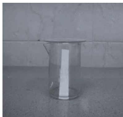
Рис. 1. Хроматографическая камера с пластиной
